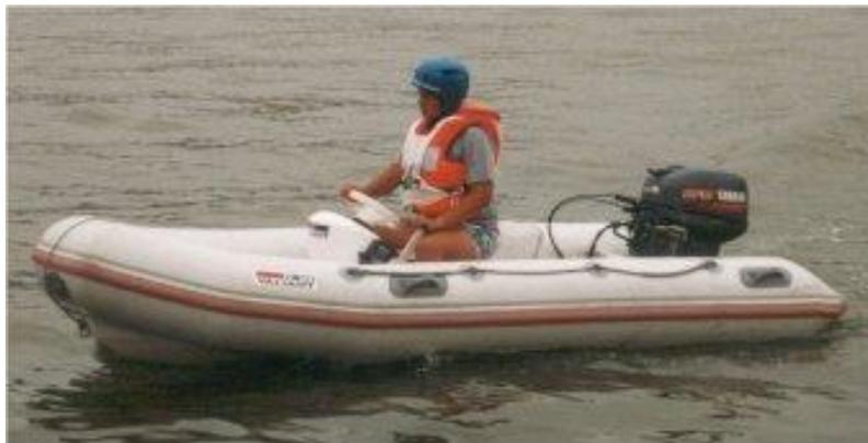
Os Pilotos das classes 4 e 5 utilizam embarcações pneumáticas com quilha rígida, volante, um corta circuitos e uma caixa de comando para acelerador e marcha à ré, instalada do lado direito da consola. As embarcações são equipadas com um motor fora de borda com potência máxima de 15 H.P. (11,2 KW), equipados com consola tipo "jockey".
