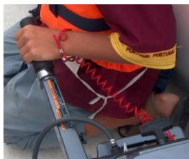
As embarcações das classes Golfinho, 1 2 e 3 devem ter dois corta-circuitos separados ou, em alternativa, um corta circuitos com duas conexões (uma para o piloto e outra para o co-piloto), para que a qualquer altura seja possível para
